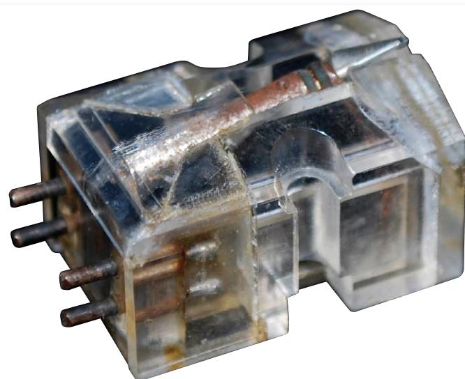
Reif für die Ruhmeshalle: Nein, das ist nicht die aktuelle Baureihe A-100, sondern der kostbare Vorserien-Entwurf der Denon-Ingenieure im transparenten Gehäuse. Das Alter von 50 Jahren erkennt man am feinen Rostschleier auf der Hülse und den Kontakten.
